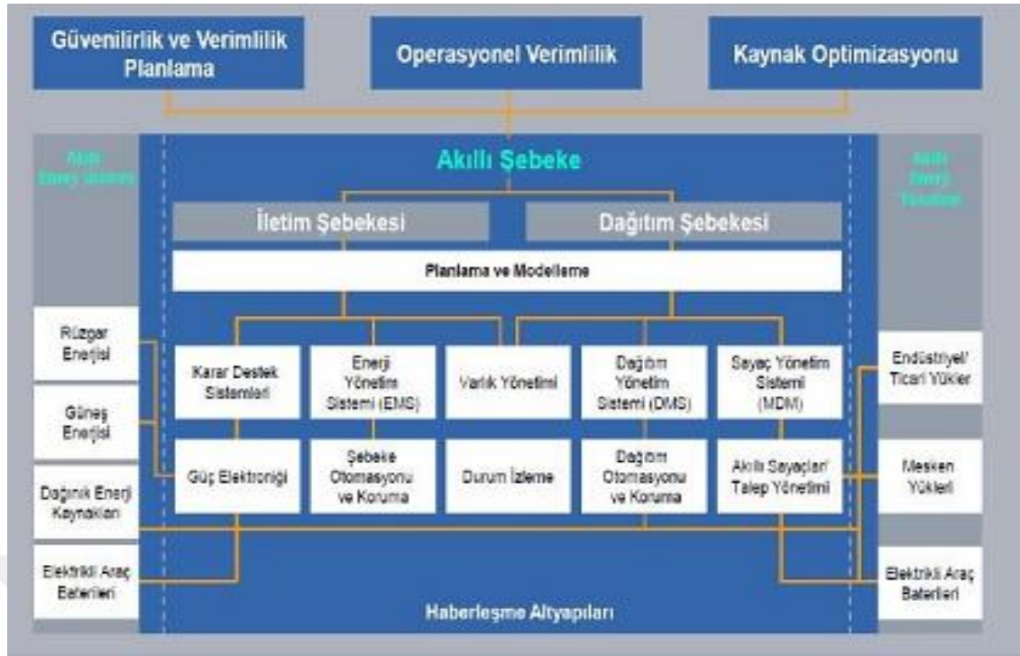
Şekil 2.5. Örnek bir akıllı şebeke sistemi genel yapısı [12]
