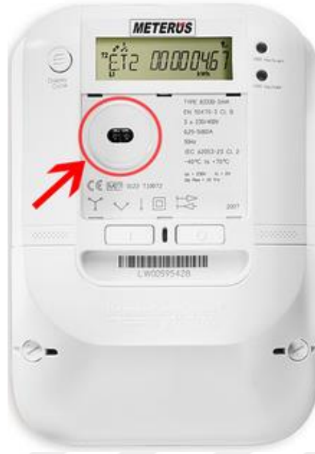
Şekil 3.1. Elektrik sayaçlarında optik port
