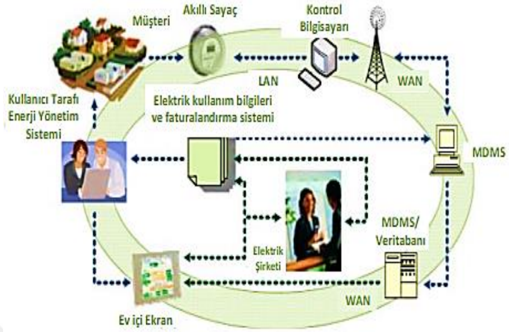
Şekil 2.3. Gelişmiş ölçüm yapısı ve bileşenleri [33]
