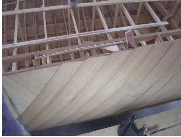
Şekil 8.4 Birbirine çarpraz çakılan gövde kaplamaları
