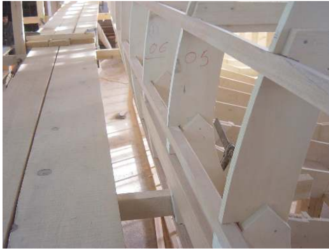
Şekil 8.12 Borda stringerlerinin dizayn postalarına montaj detayı
