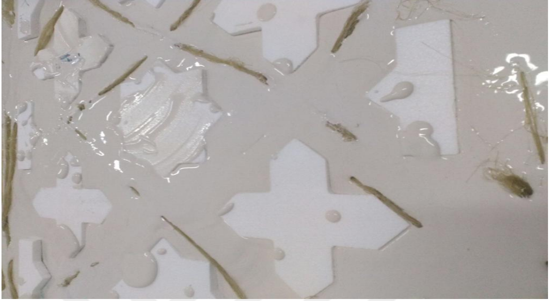
Resim-58: Alçı dökümü ve keten liflerin yerleştirilmesi
