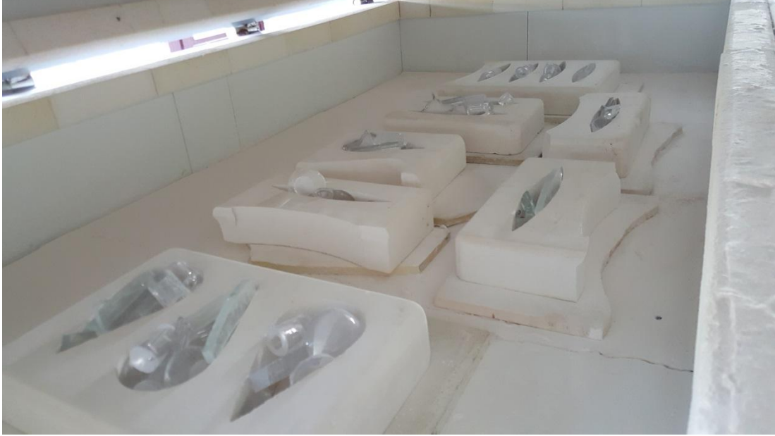
Resim.53-54: Pişirme hazır kalıplar ve pişirim sonucu elde edilen camlardan örnekler
