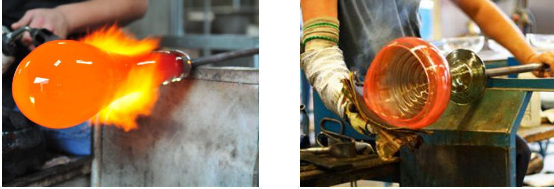
Resim10-11: Üfleme Tekniği yapım aşamaları
