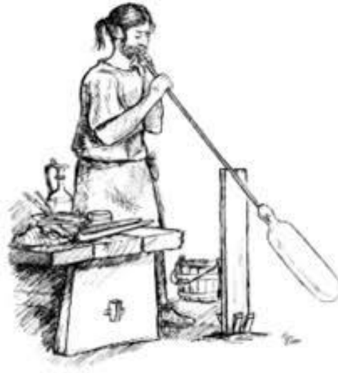
Resim-9: Cam üfleme yöntemi
