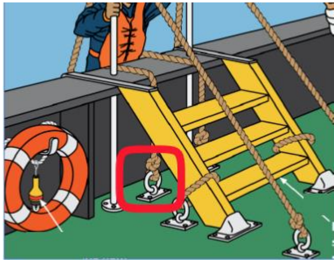
Şekil 11. Küpeşte merdiveni ve tutamaçların sabitlenmesi
