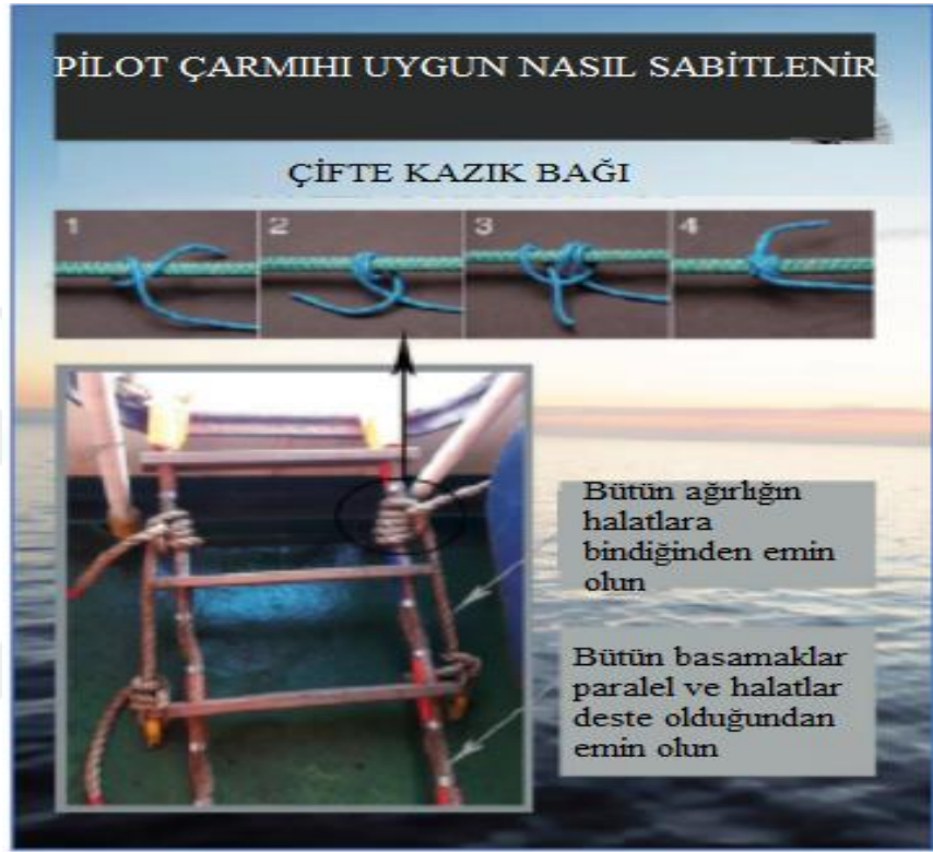
Şekil 13. Pilot çarmihını çift kazık bağı bağlama yöntemiyle sabitlenmesi
