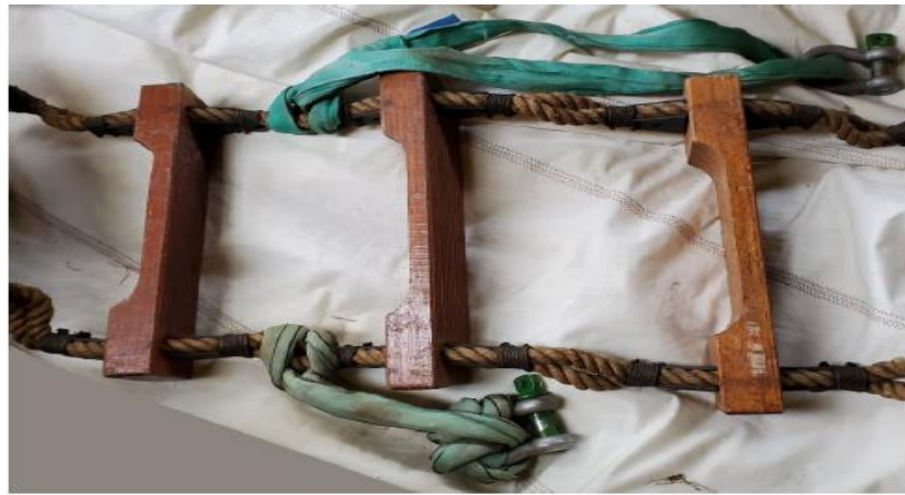
Şekil 12. Pilot çarmıhının ortasından yan halatlarına ters kazık bağı
