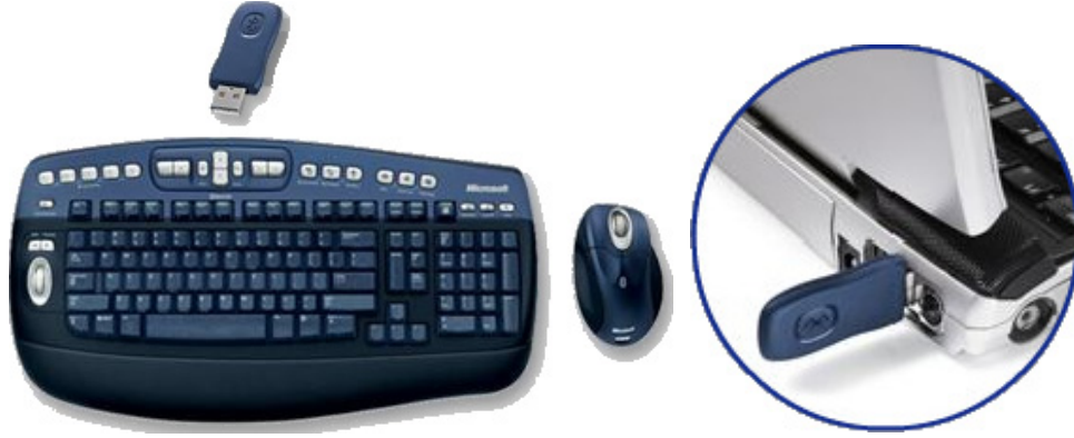
Resim 6.2. Bluetooth klavye ve fare (solda), USB alıcı/verici (sağda) (98)
