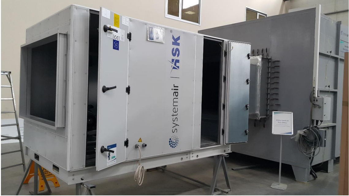
Şekil 4.1 Klima santrali test ünitesi genel görünüm
