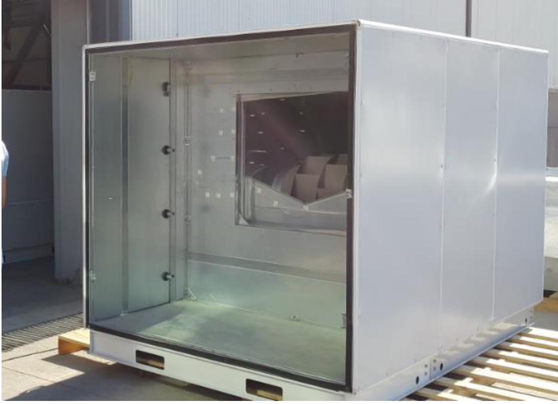
Şekil 4.2 Difüzörü sökülmüş boş hücre
