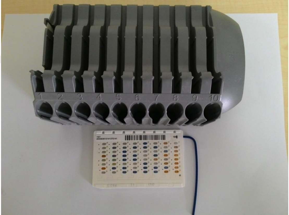
Şekil 5. Vitek 2 otomatize sisteme ait özel kaset ve ID-YST kartı.
