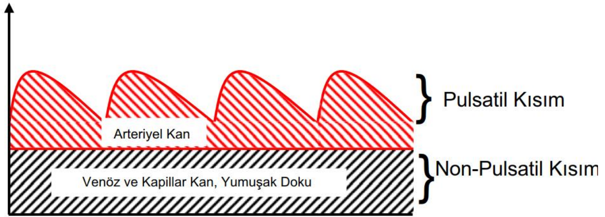
Şekil 4: Pulse Oksimetre çalışma prensibi
