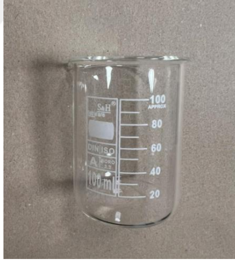
Resim 3.1 Zamanlı Su Yutma Testi 100 ml’lik ölçü kabı
