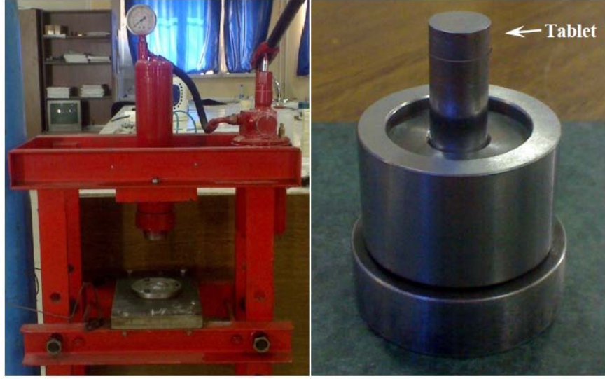
Resim 3.1 Hidrolik pres, elik kalıp ve tablet haline getirilen toz numune.
