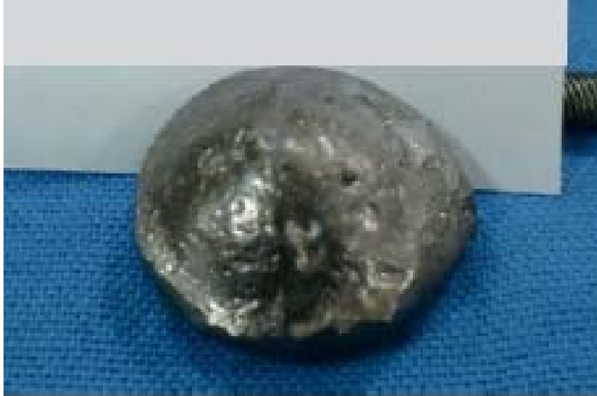
Resim 3.2 Ön ergitme işlemi tamamlanmış master alaşım numunesi (90-100gr)
