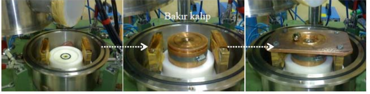
Resim 3.4 Ergitme ve döküm işleminin gerçekleştirildiği alt kalıp (Yazıcı 2011).
