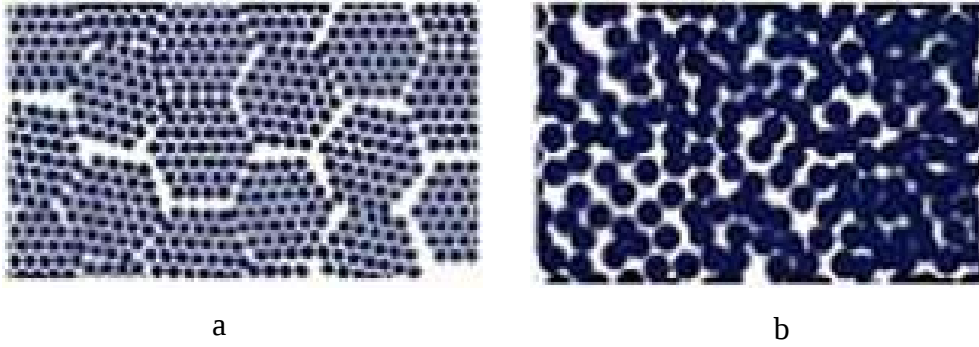
Şekil 2.3 Konvansiyonel metallerin kristalin yapısı (a) ve metalik camların amorf yapısı(b) (İnt.Kyn1).
