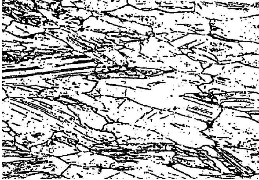
Şekil 3.17. 1065 °C’de 1 saatlik çözeltiye alma işleminden sonra 4 Saat 535°C’de tavllanmış MP-35’in mikroyapısı. (Metals Handbook, 1985)
