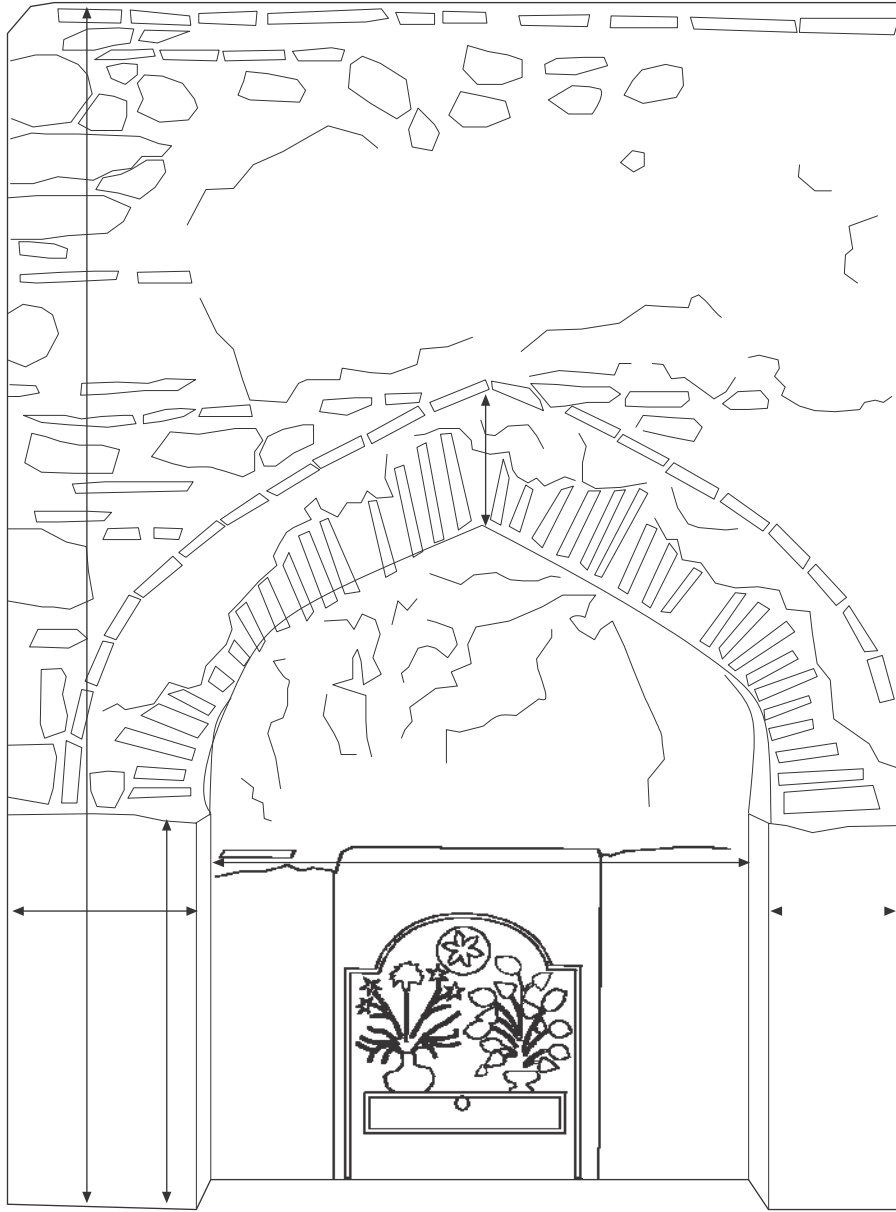
Çizim No 7. Emine Hanım Çeşmesi Görünüş-Kuzey Cephesi
