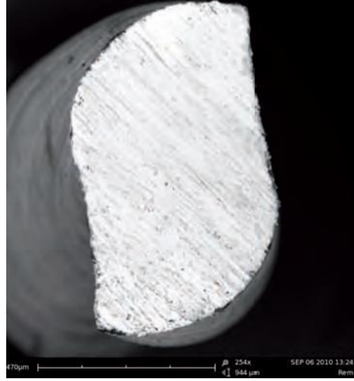
Resim-7: Reciproc döner eğe sisteminin çapraz kesiti (94)
