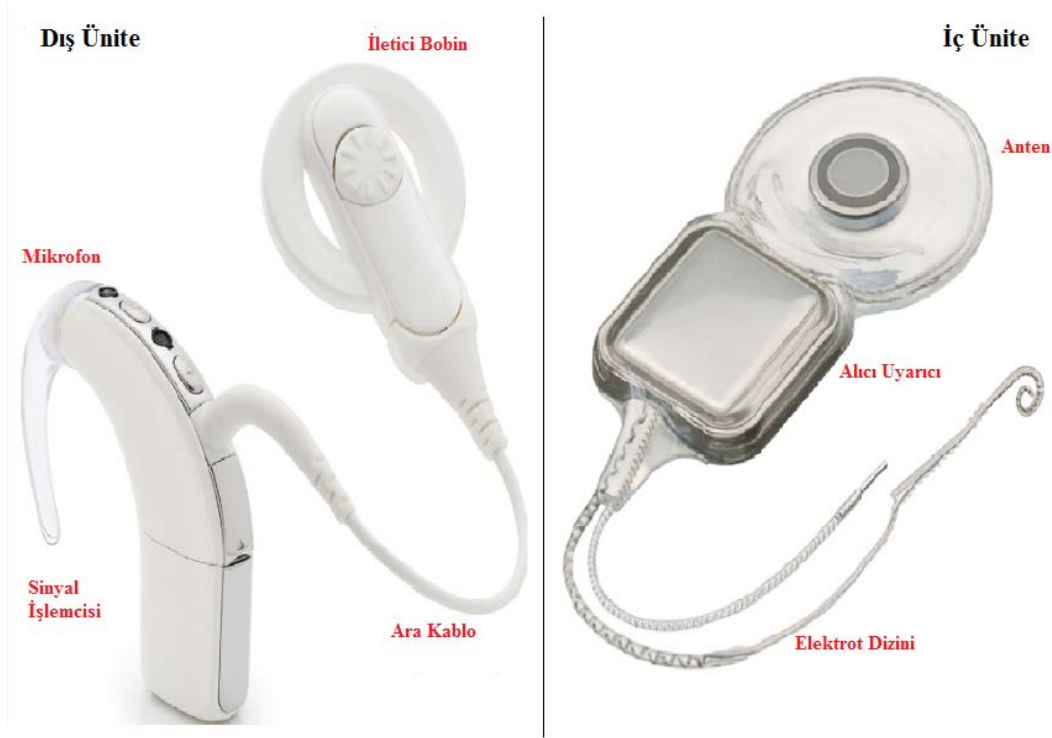
Şekil 7: Koklear implant dış ve iç parçaları
