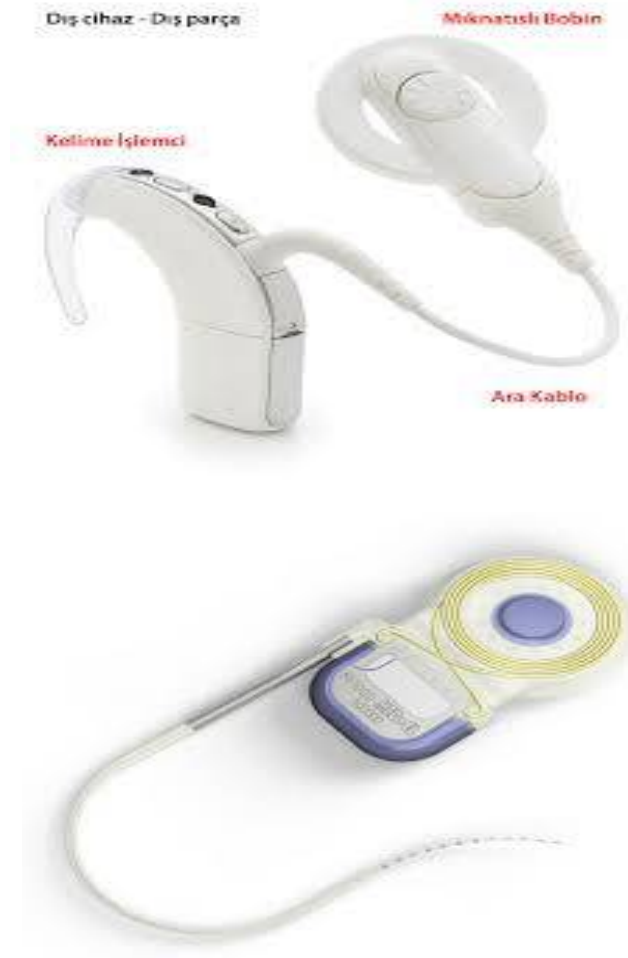
Şekil 4: Koklear implant dış ve iç parçaları
