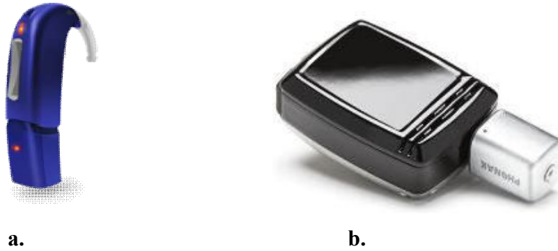
Şekil 8. a. Oticon Safari işitme aygıtı ve ona uyumlu Oticon Amigo FM alıcısı, b. Cochlear BAHA kemik yolu işitme aygıtı ve Phonak mLxi Dinamik FM alıcısı (15, 16)
