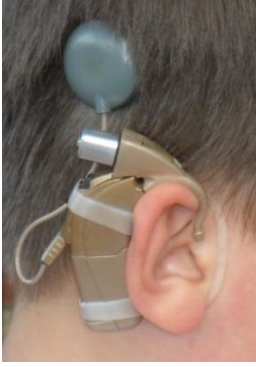
Şekil 14. Advanced Bionics Auria BTE konuşma işlemcisi+ Phonak mLxi Dinamik FM alıcısı
