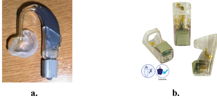
Şekil 7. a. Phonic Ear FM sistem alıcısı, FM adaptörü ile Oticon işitme aygıtına takılmış, b. Oticon FM adaptörleri (14)
