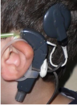
Şekil 13. Med-El Opus 2 BTE konuşma işlemcisi+ Phonak mLxi Dinamik FM alıcısı
