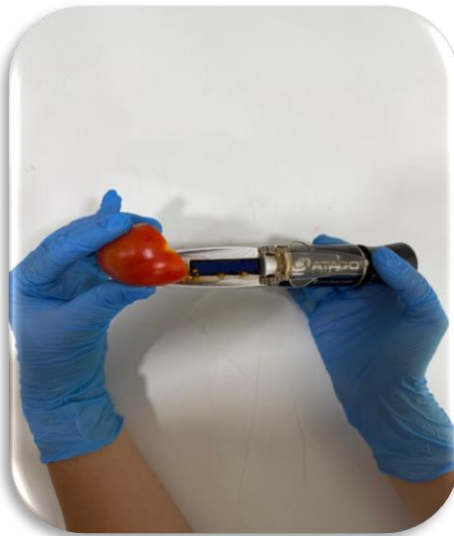
Şekil 3. 12. Meyve SÇKM ölçümü
