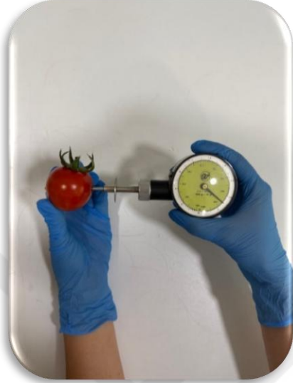
Şekil 3. 11. Meyve eti sertlik ölçümü
