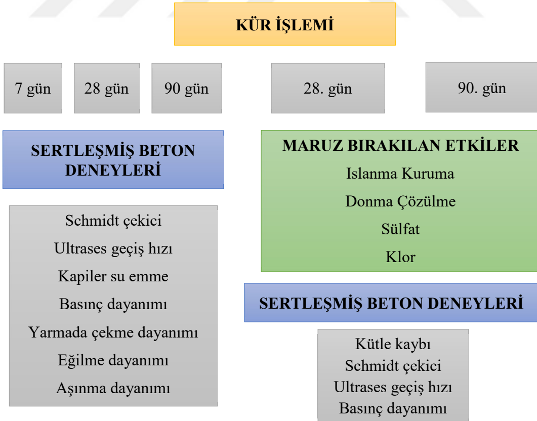
Şekil 8. Beton numunelerin kür edilmesi ve sertleşmiş beton deneyleri.
