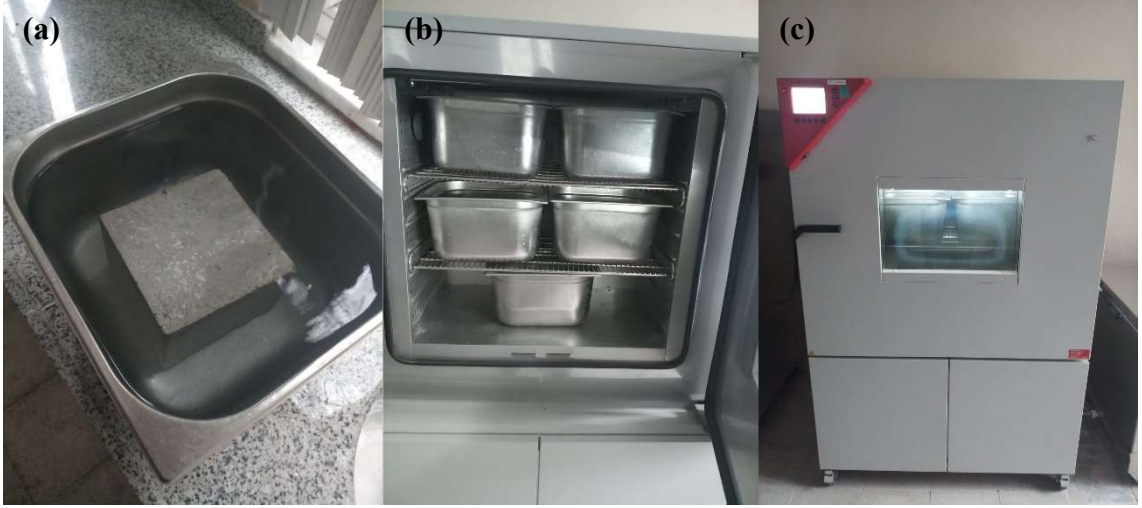
Şekil 19. (a) Numune kaplarına beton ve su yerleştirilmesi (b) Numune kaplarının cihaza yerleştirilmesi (c) donma ve çözülme cihazı.
