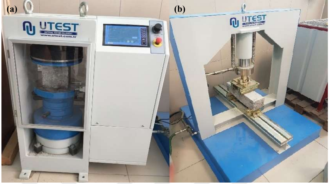
Şekil 14. (a) Basınç dayanım deney presi ve (b) Eğilme dayanımı deney görüntüsü.
