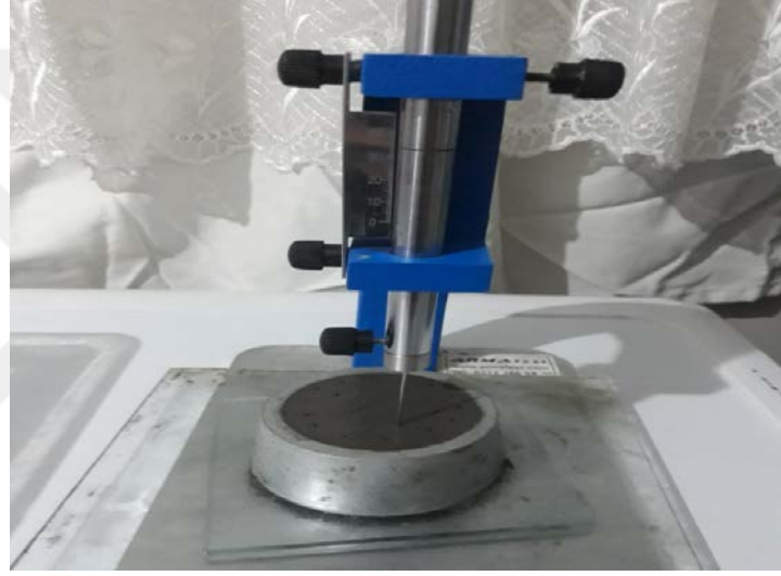
Şekil 3. 11: Vicat deneyi priz başlama süresi tayini.
