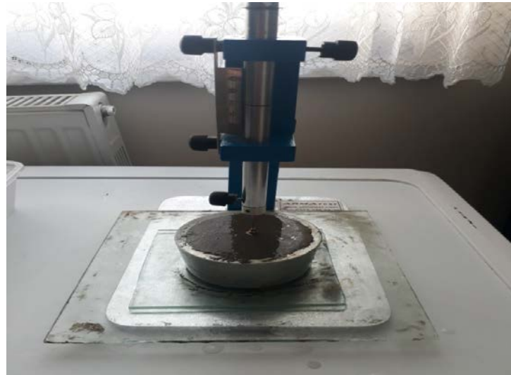
Şekil 3. 12: Vicat deneyi priz sona erme süresi tayini.
