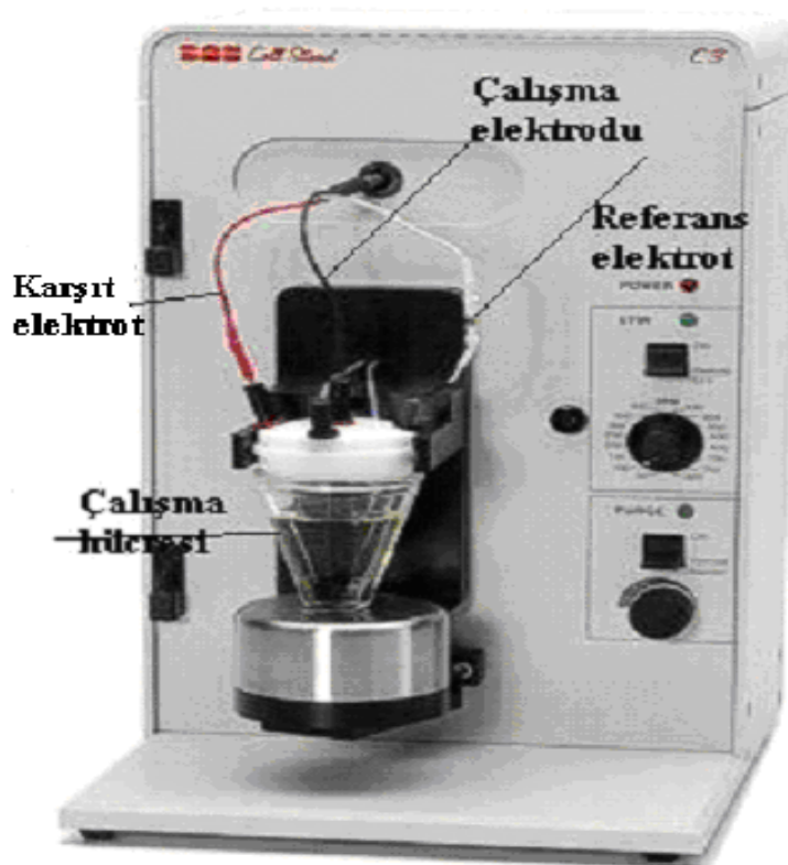
Şekil 3.1. Kaplama ve ölçme yapmada kullanılan hücre sistemi
