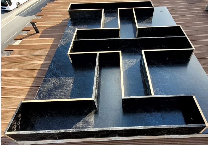
Şekil 3.11. Deney numuneleri için hazırlanan plywood kalıplar.
