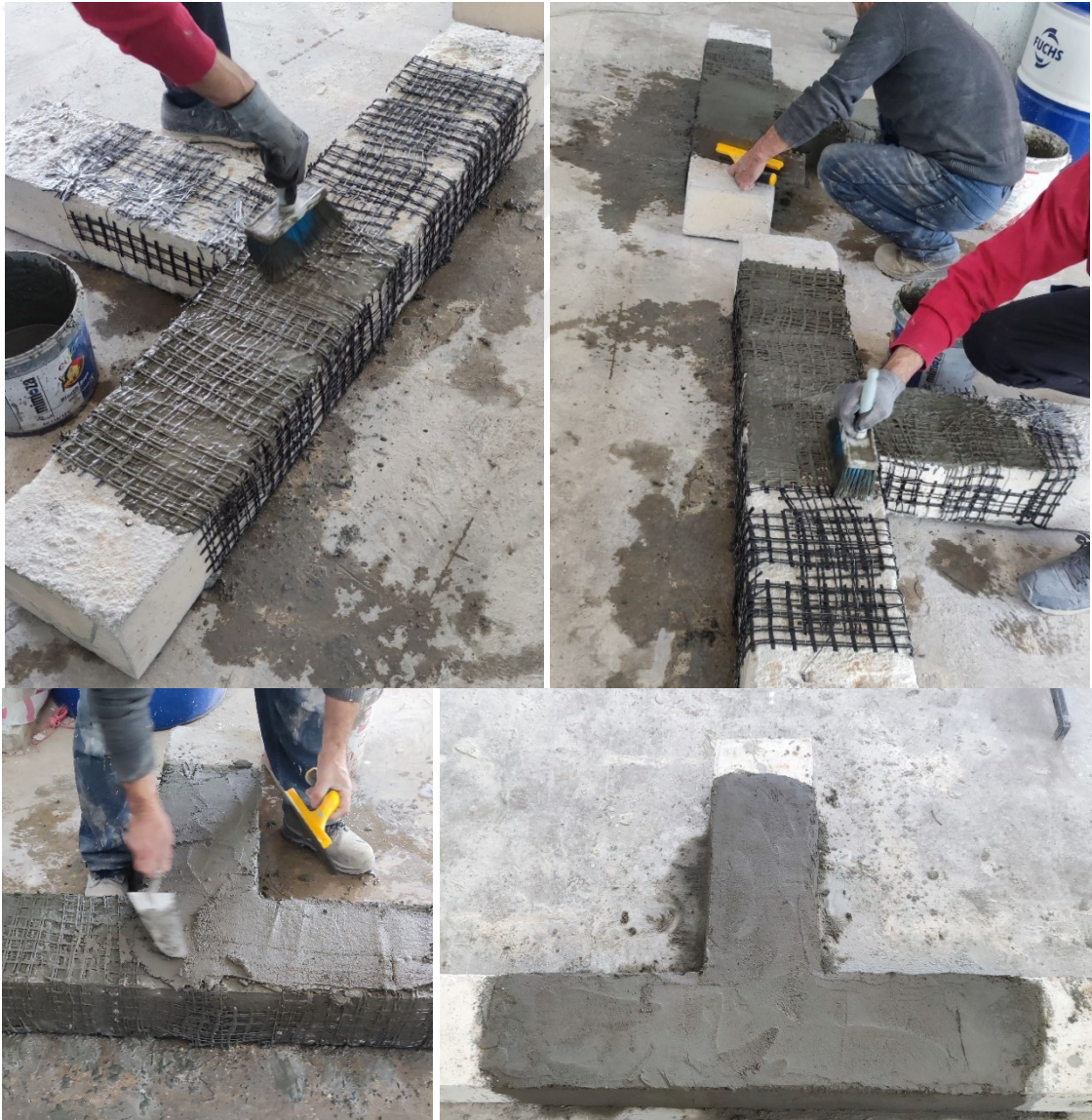
Şekil 3.16. Deney numunelerine astar ve sıva uygulanması işlemleri.
