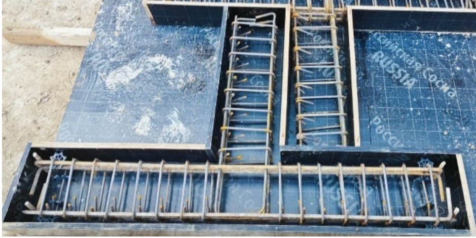
b) S-1 – S-7 numunelerine ait donatı düzeni
