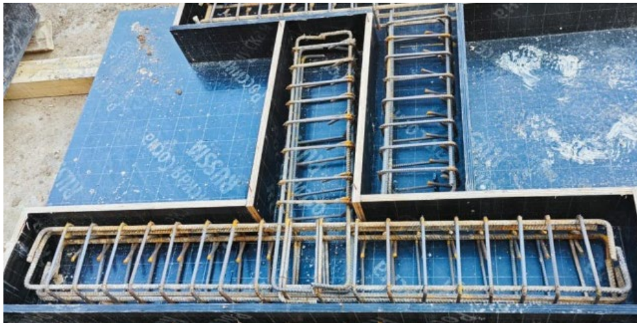
a) S-2 numunesine ait donatı düzeni
