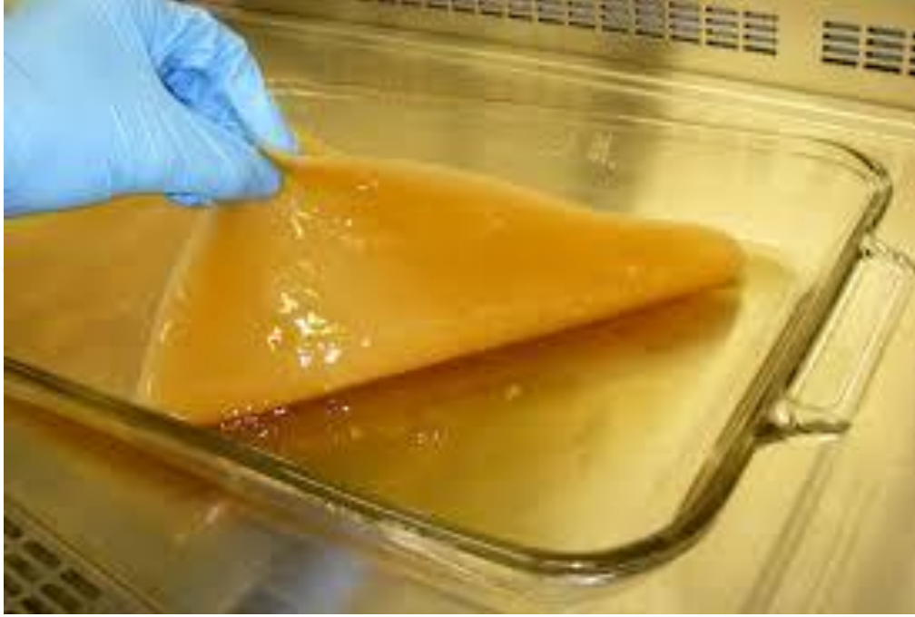
Şekil 1.10 : Mikrobiyal selüloz üretiminde geniş alanda statik yöntem uygulaması ( https://mimoza.marmara.edu.tr/ )
