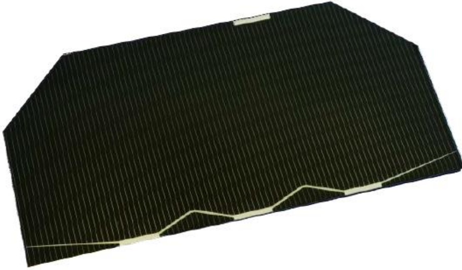
Şekil 3.15 : Azur Space %30 verimli GaAs güneş hücresi [39].
