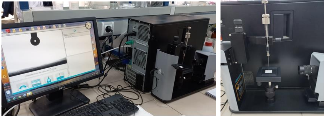
Şekil 3.6. (A) Temas açısı ölçüm cihazı; (B) Yama yüzeyine suyun damlatılması
