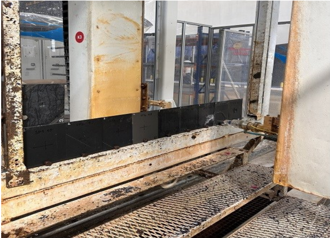
Görsel 3.33. İkinci darbe testi sonrası TTU ultrasonik muayene
