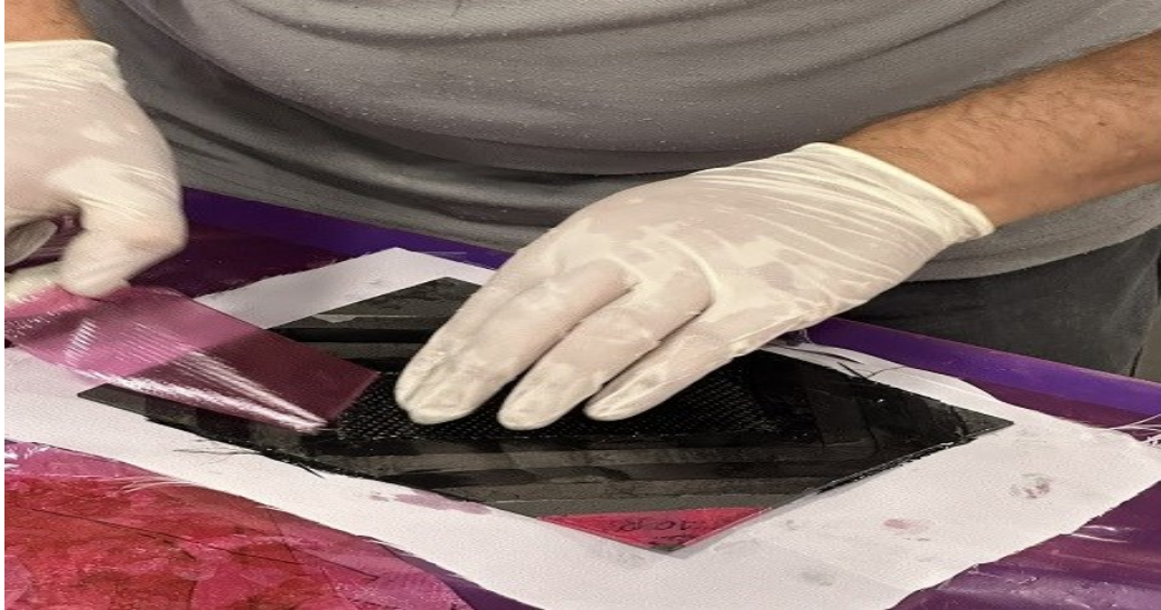
Görsel 3.22. Kompozit tamir işlemleri
