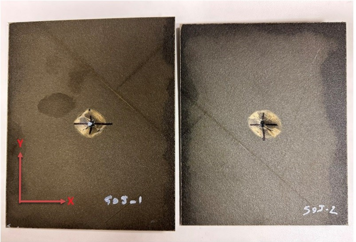
Görsel 3.9. 50J darbe testi uygulanmış numune 9-10
