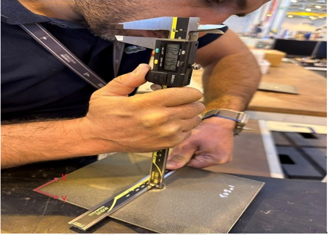
Görsel 3.11. 50J darbe testi uygulanmış numunede hasar derinlik ölçümü
