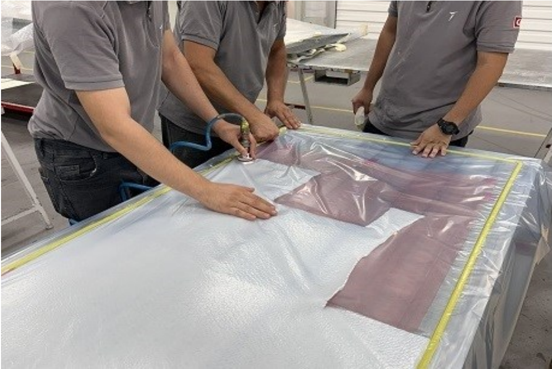
Görsel 3.24. Kompozit tamir işlemi sonrası vakumlama
