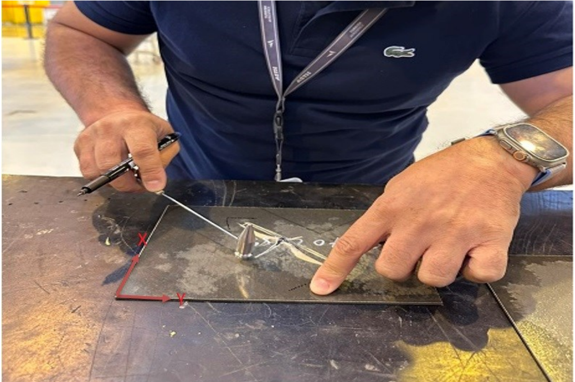
Görsel 3.12. 50J darbe testi uygulanmış tap muayenesi
