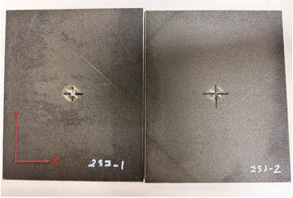
Görsel 3.8. 25J darbe testi uygulanmış numune 7-8
