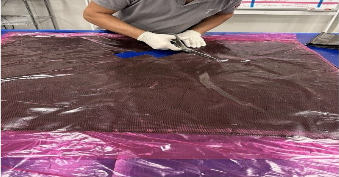
Görsel 3.21. Kompozit tamiri şablon hazırlama
