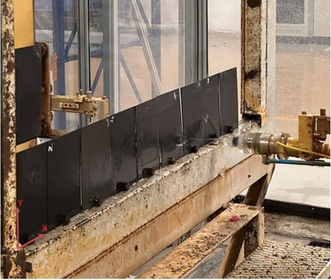
Görsel 3.26. Kompozit tamiri sonrası TTU ultrasonik muayene
