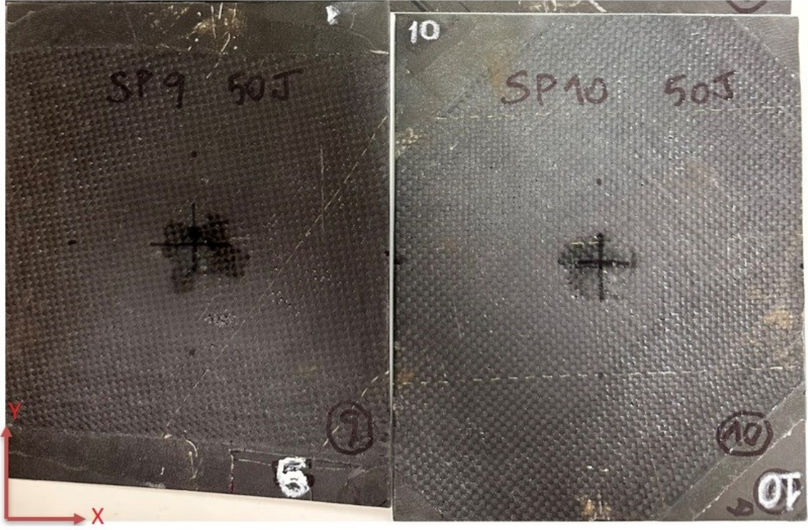
Görsel 3.31. İkinci kez 50J darbe testi uygulanmış numune 9-10
