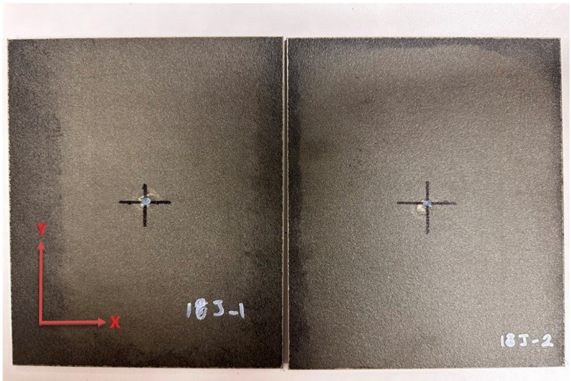
Görsel 3.7. 18J darbe testi uygulanmış numune 5-6
