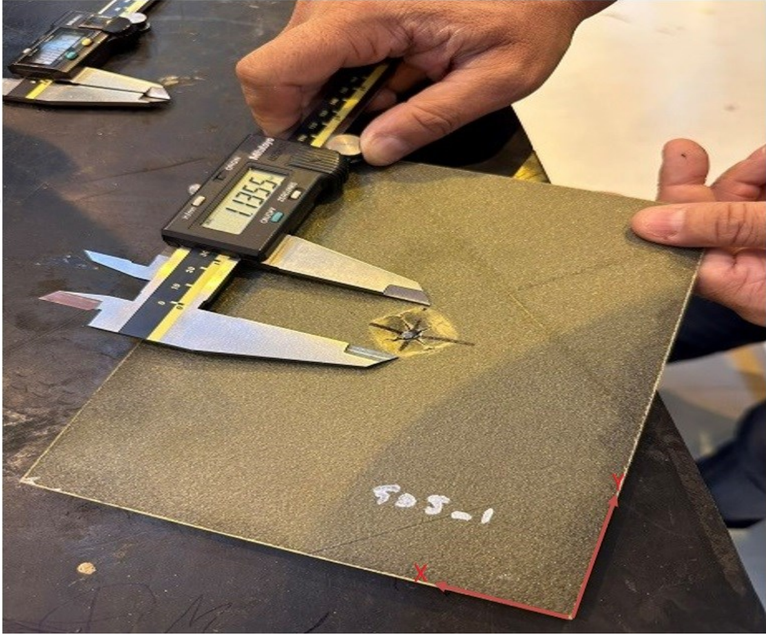
Görsel 3.10. 50J darbe testi uygulanmış numunede x eksenli hasar ölçümü
