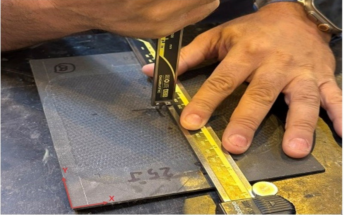
Görsel 3.32. İkinci darbe testi sonrası tap muayenesi
