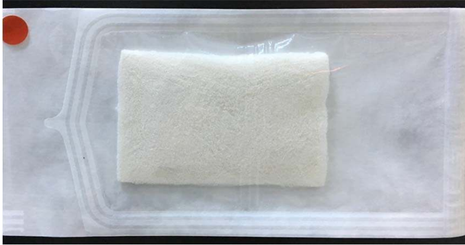
Şekil 3.2. Gamma radyasyon ile sterilize edilen kompozit greft materyali
