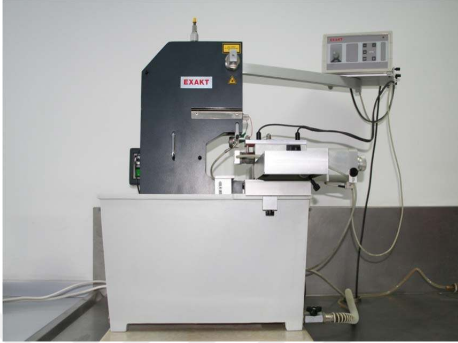
Şekil 3.13. Exact 300 CL Hassas kesme ünitesi
