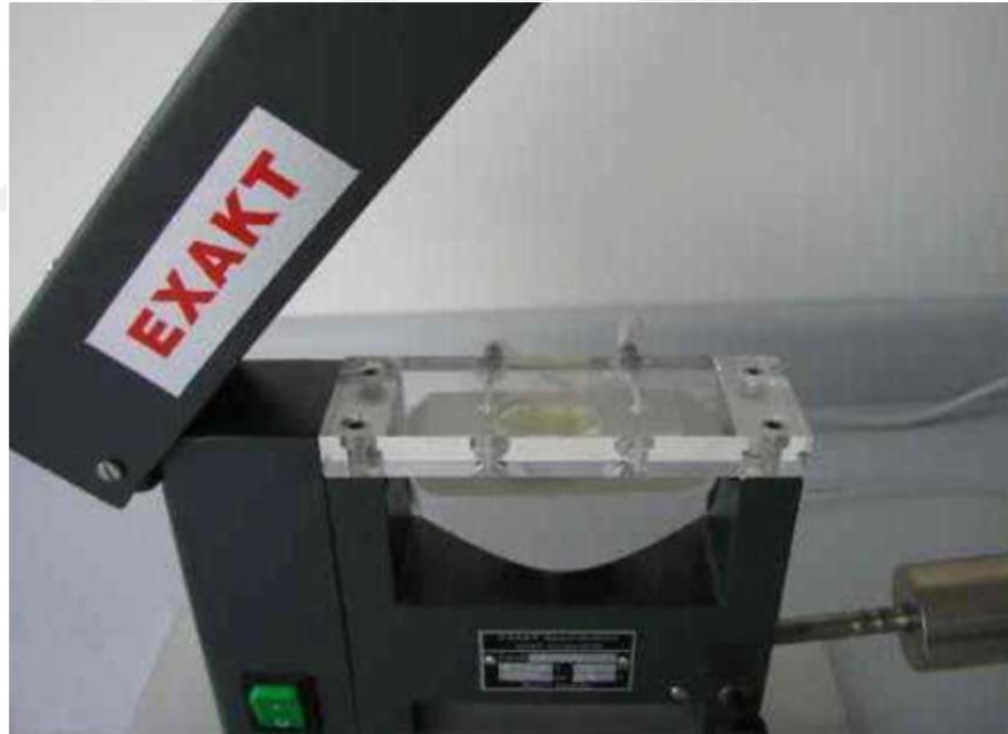
Şekil 3.12. Pleksiglas yapıştırma ünitesi
