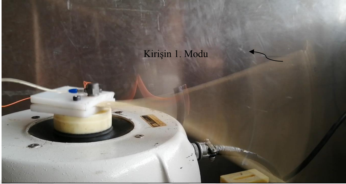
Şekil 3.17. Numunenin birinci modunun gösterimi
