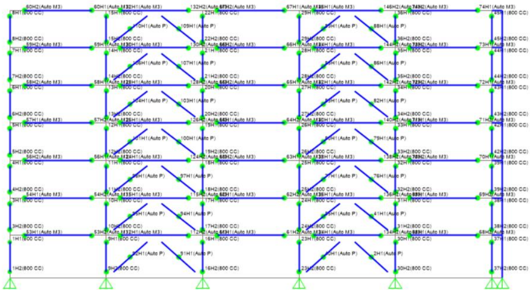
Şekil 3.43. Merkezi çaprazlı çerçeve sistemin plastik mafsalları görünümü
