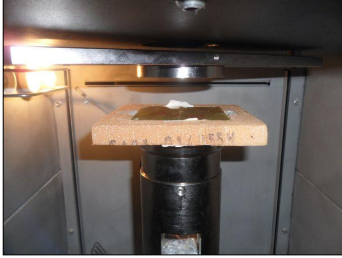
Şekil 5.14 Ağırlık düşürme darbe deneyi test düzeneėi.
