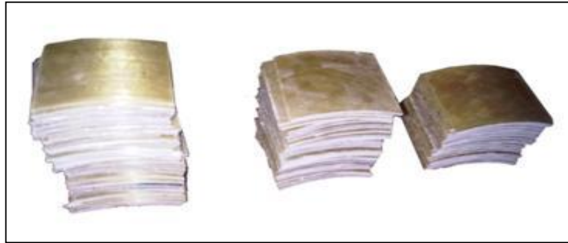
Şekil 5.2 Sırasıyla 320 mm (0°), 250 mm (55°), 200 mm (55°) numuneleri
