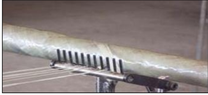
Şekil 5.3 Elyafların sarım yöntemi (İZOREEL)
