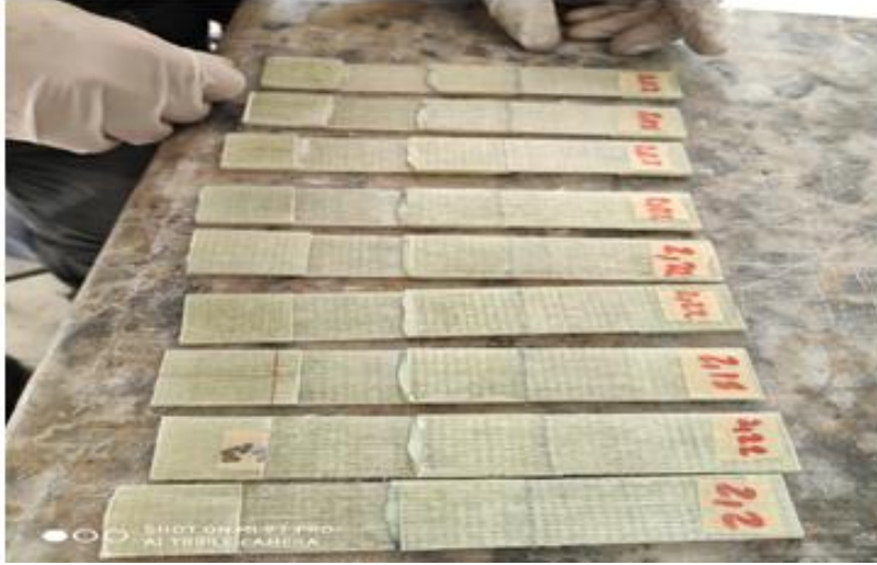
Şekil 3.30. Numunelerin yapıştırma işlemlerinin bitmiş hali
