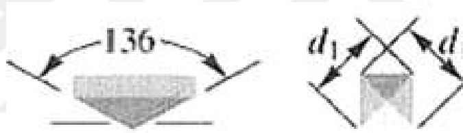
Şekil 3.18. Elmas piramidin batırılma şekli
