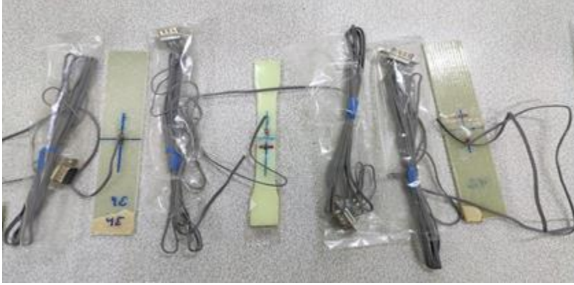
Şekil 3.34. Numunelere gerinim pulu yapıştırılmış hali
