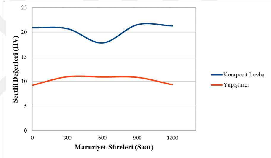
Şekil 5.1. UV ışınlarına maruz kalan kompozit levha ve yapıştırıcıdan elde edilen sertlik değerlerinin grafiği
