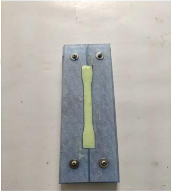
Şekil 3.31. Yapıştırıcının kalıp içerisine dökülmüş hali
