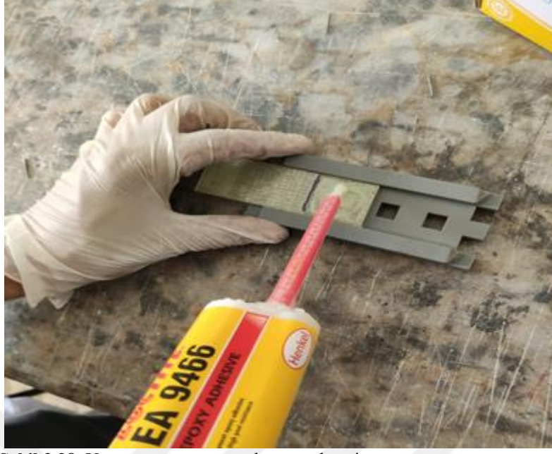
Şekil 3.28. Yapıştırıcının numunelere sürülmesi
