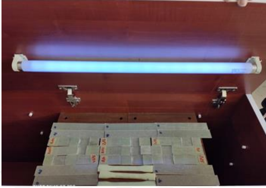
Şekil 3.32. Numunelerin UV test cihazına yerleştirilmesi
