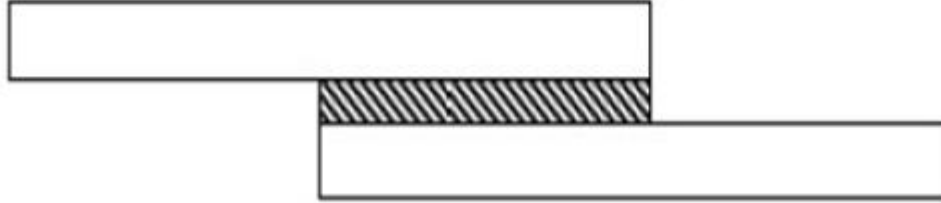
Şekil 3.7. Bindirmeli bağlantı (Kaya 2005)
