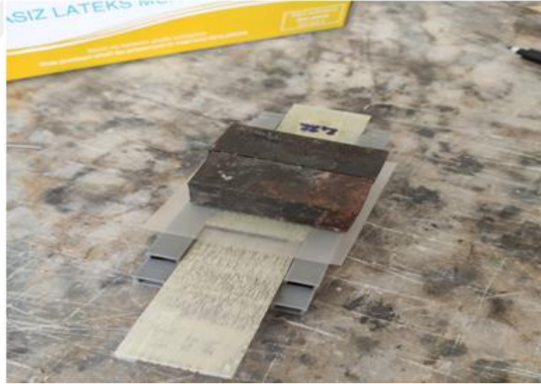
Şekil 3.29. Numunelerin yapıştırma işlemi
