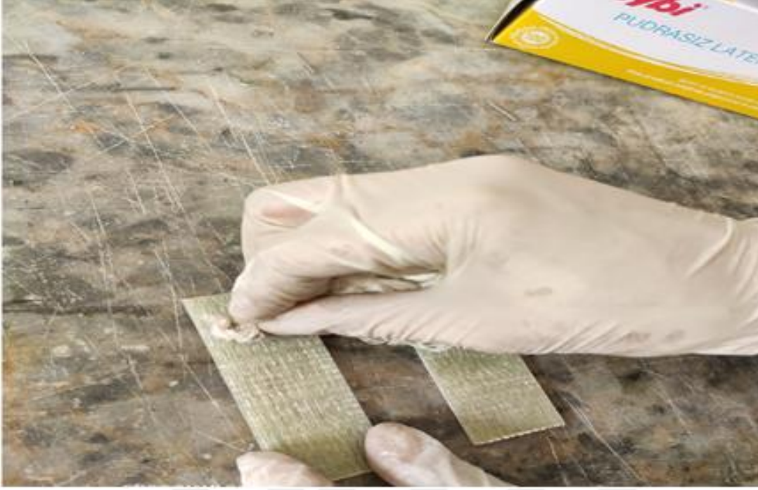
Şekil 3.27. Zımparalanan numunelerin aseton ve temiz bez yardımı ile yüzey temizleme işlemi
