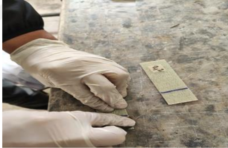
Şekil 3.26. Çizim ve zımparalama işlemi
