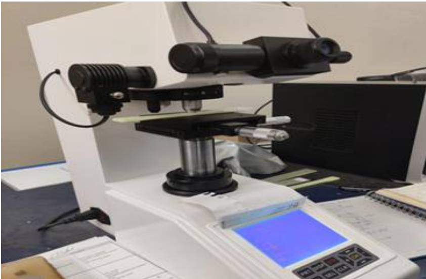
Şekil 3.35. Numunelerin mikro-sertlik ölçüm cihazına yerleştirilmesi
