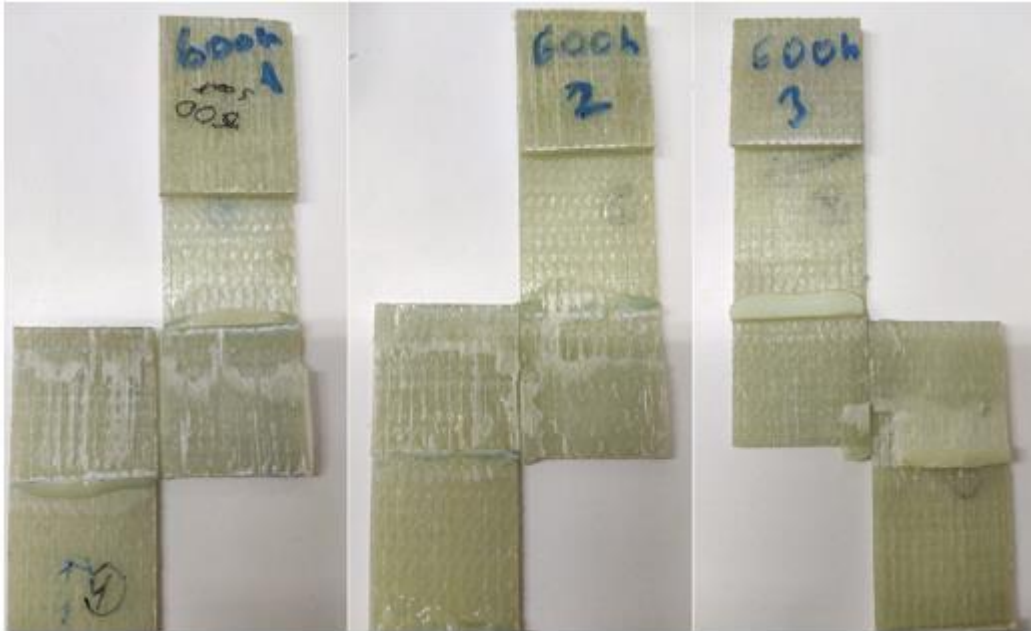
Şekil 5.8. 600 saat UV ışınlarına maruz bırakılan tek tesirli yapıştırma bağlantı numunelerinde oluşan hasar tipleri
