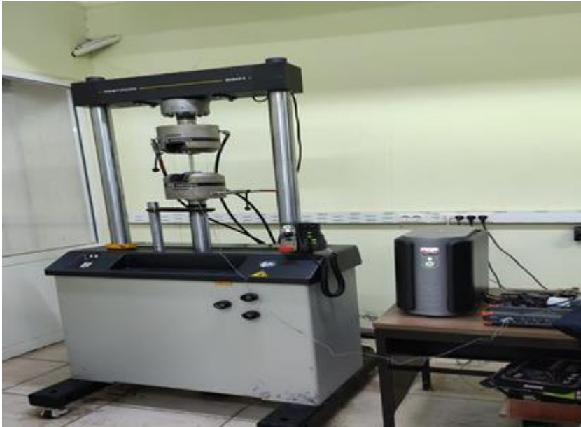
Şekil 3.38. Gerinim pulu yapıştırılmış numunelerin statik çekme cihazı ve gerinim pulu cihazına bağlanması
