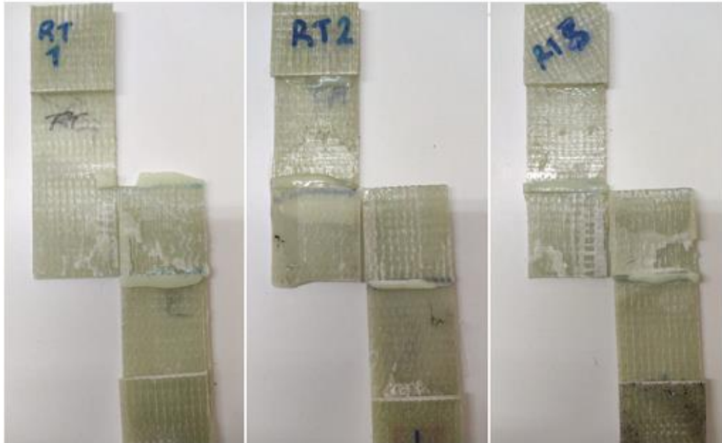
Şekil 5.6. Oda şartlarındaki tek tesirli yapıştırma bağlantı numunelerinde oluşan hasar tipleri
