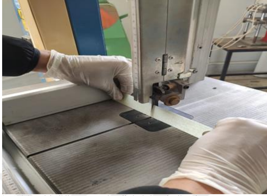
Şekil 3.25. Elektrikli testere yardımı ile levhaların kesilmesi
