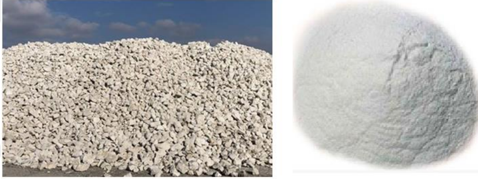
Şekil 3.3. Karbonatlama atığı (kireç atığı)
