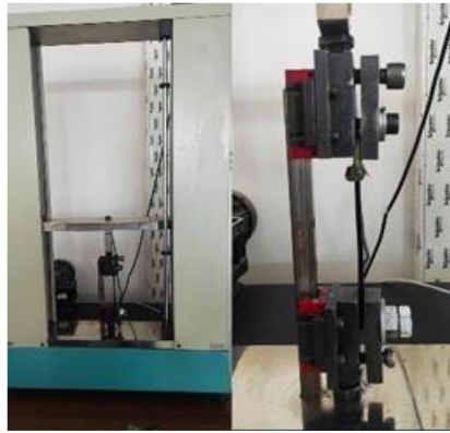
Şekil 3.6. Çekme testi cihazı ve çekme testi yapılan numune görüntüsü
