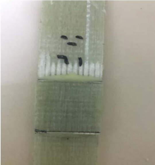
Şekil 5.10. Kırılmanın numunede gerçekleştiğini gösteren durum
