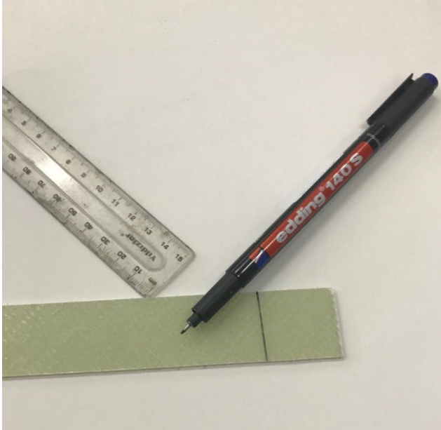
Şekil 4.4. Zımparalama işlemi için gerçekleştirilen çizme işlemi
