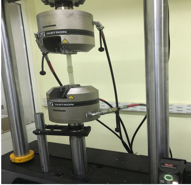
Şekil 4.10. Test çekme cihazı ve çenelere bağlanmış numune
