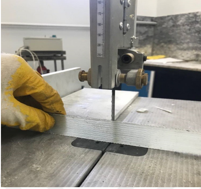
Şekil 4.3. Elektrikli testere yardımı ile levhaların kesilmesi
