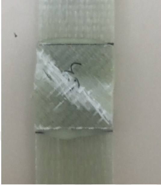
Şekil 5.11.Yama fiber açısı yönünde kırılma
