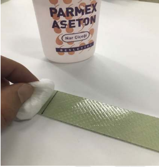
Şekil 4.5. Zımparalanan numunelerin aseton yardımı ile yüzey temizleme işlemi
