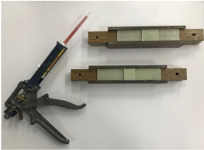
Şekil 4.7. Yapıştırma işleminde kullanılan kalıplar ve tabanca
