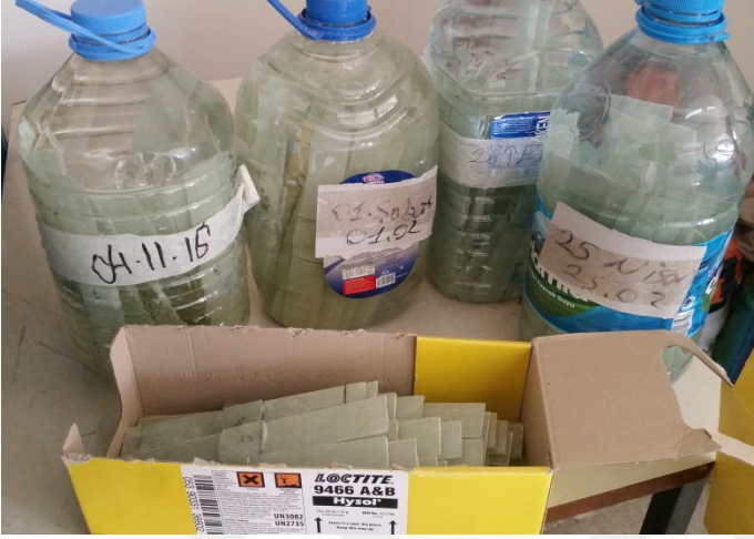
Şekil 4.8. Deniz suyu beklemeye bırakılmış numuneler.
