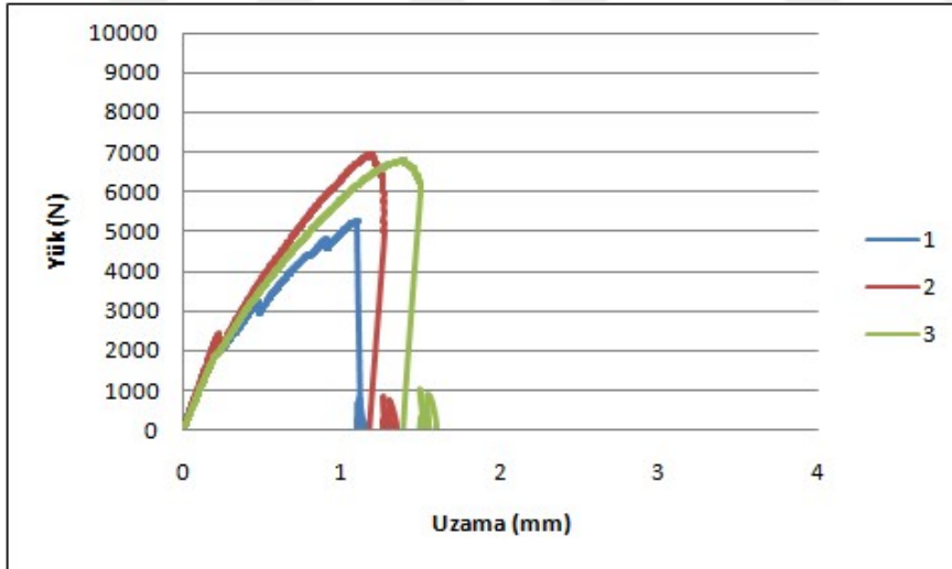
Şekil 4.14. Kuru halde tek yüzü yamalı [30^\circ]_8 levhalar için elde edilen yük-uzama değerleri
