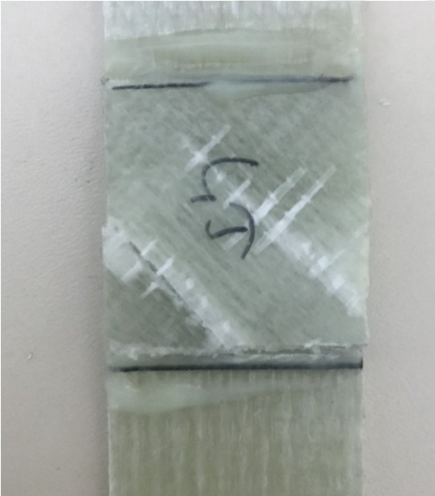
Şekil 5.14. Birden fazla bölgede kırılma
