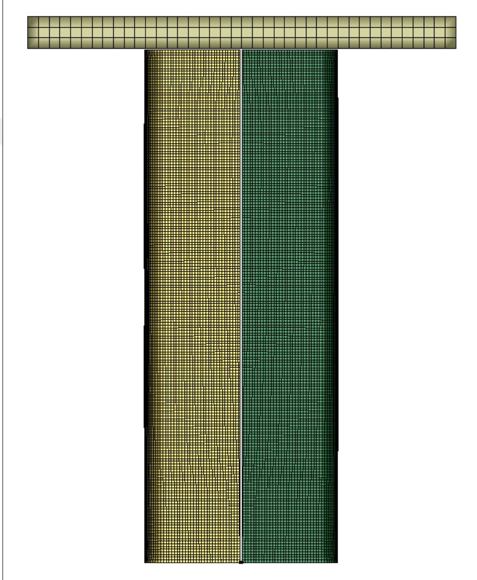
Şekil 34. Değişken kalınlığa sahip enerji sönümleyici tüpün sonlu elemanlar modeli
