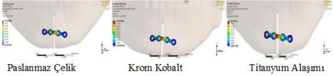
Şekil 3.7. Tek I plak üzerinde oluşan gerilmeler [129].
