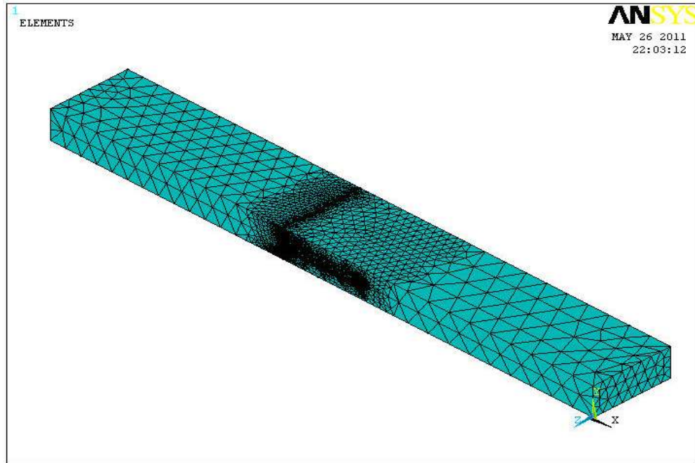
Şekil 3.20 Geçmeli bağlantı tasarımının sonlu eleman modeli
