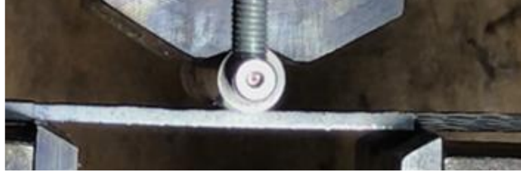
Şekil 2.24. Üç nokta eğilme testi numunesi
