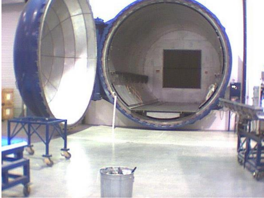
Şekil 1.8. Kompozit yapı üretiminde kullanılan otoklav fırını (URL-4, 2022).
