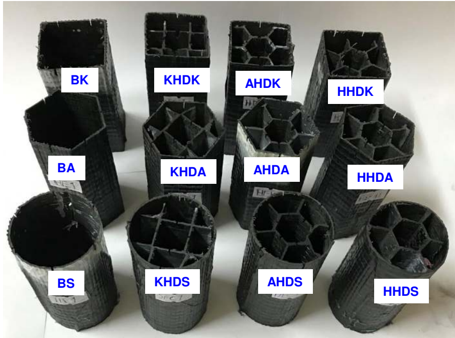
Şekil 2.11. KETP kompozit çarpışma kutularına hasar tetikleyici kanalların açılması ve türlerine göre hücresel gözenekli kısımların dış duvarlara yüzey temaslı olarak yerleştirilmesi
