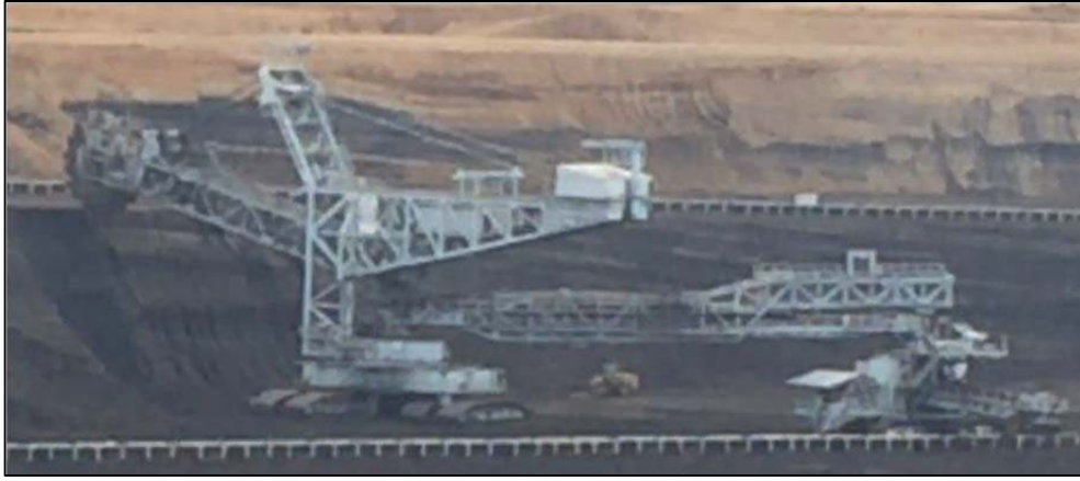
Şekil 3.3. Döner kepçeli ekskavatör görünümü
