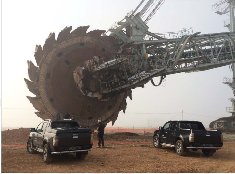
Şekil 3.4. Döner kepçeli ekskavatörde kazı işlemini yapan kısmın görünümü
