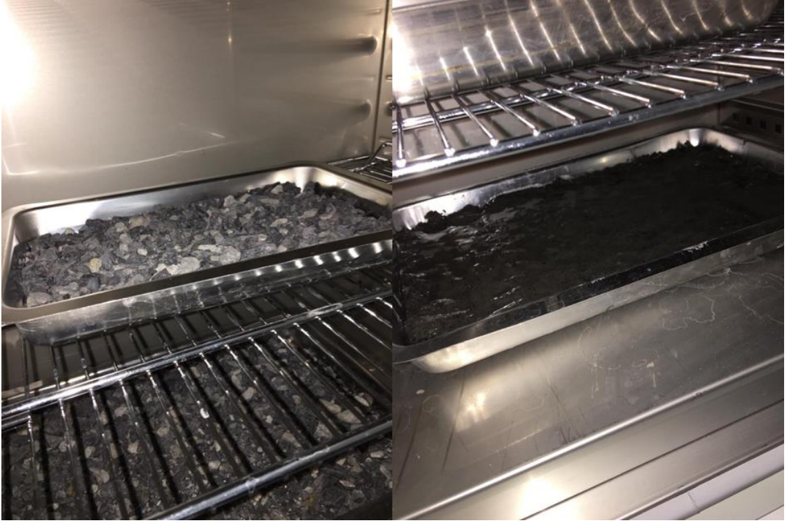
Şekil 3.1: Kömür madencilik atıklarının ve kömür yıkama atıklarının etüvde kurutulması
