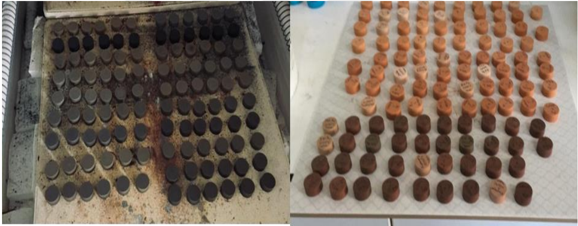
Şekil 3.4: Tuğla numunelerinin pişirmek için fırına yerleştirilirken ve pişirme işlemi sonrası durumu
