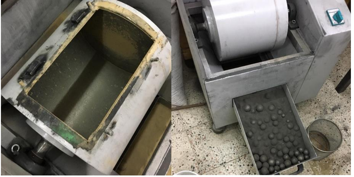
Şekil 3.2: Kurutulan hammaddelerin bilyalı değirmende öğütülmesi
