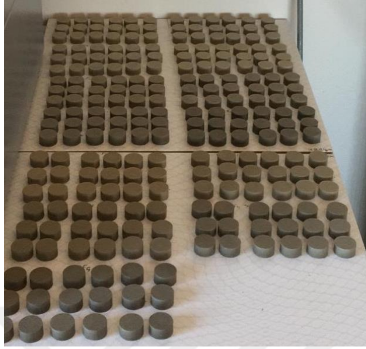
Şekil 3.3: 50 bar basınç altında preste basılan tuğla numuneleri
