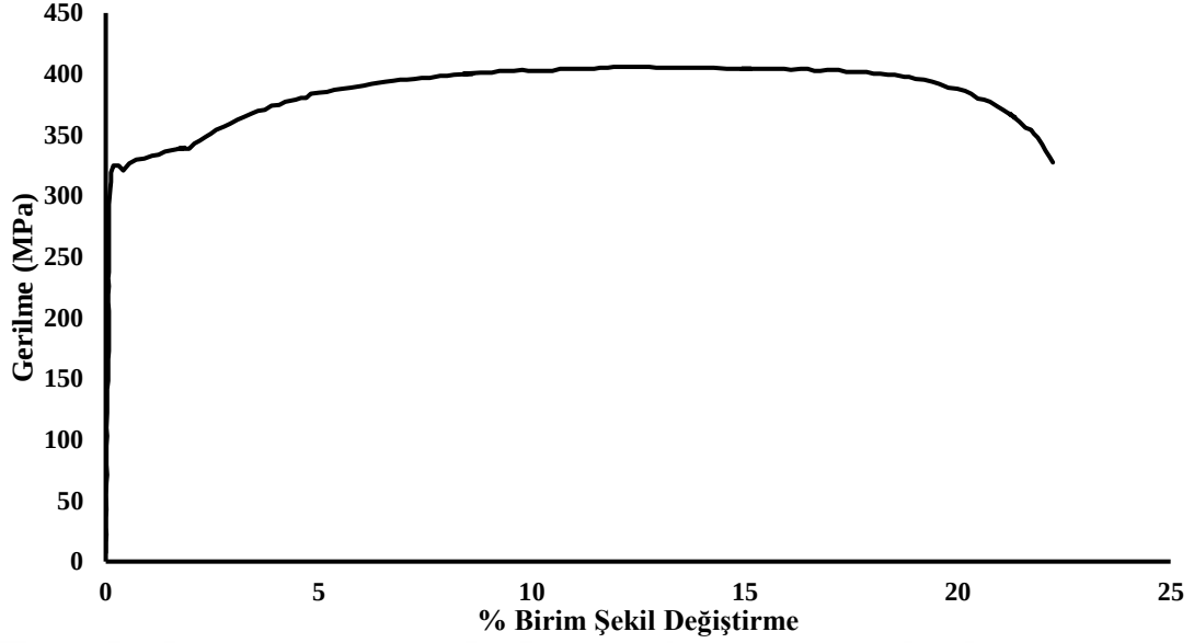
Şekil 4.4. 2.5 mm kalınlıktaki numune için gerilme-birim şekil değiştirme eğrisi.
