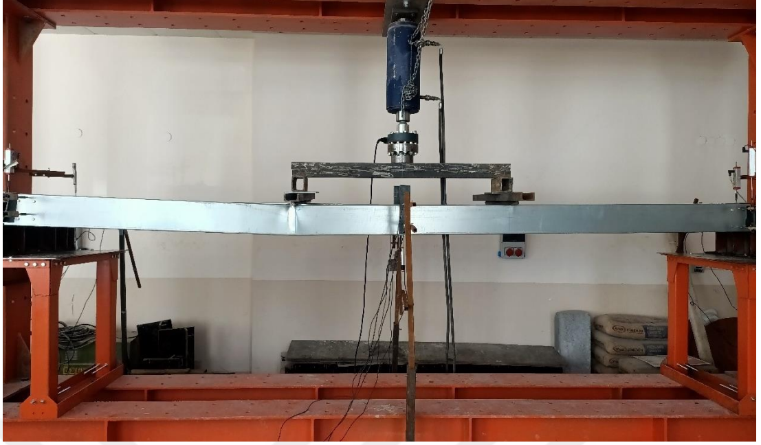
Şekil 4.64. Deney elemanının göçme şekli.
