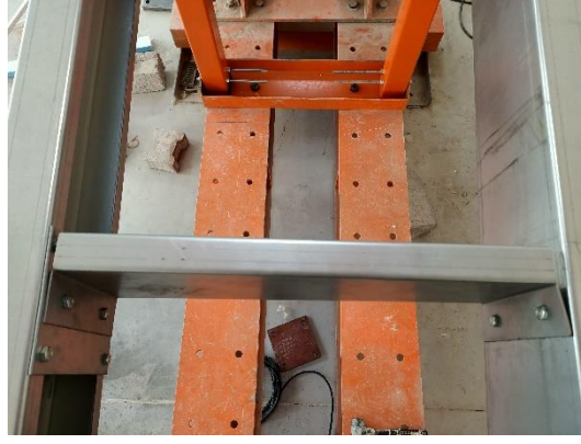
Şekil 4.46 (devam). Bağlantı kirişi levhasında oluşan lokal ezilme (c).
