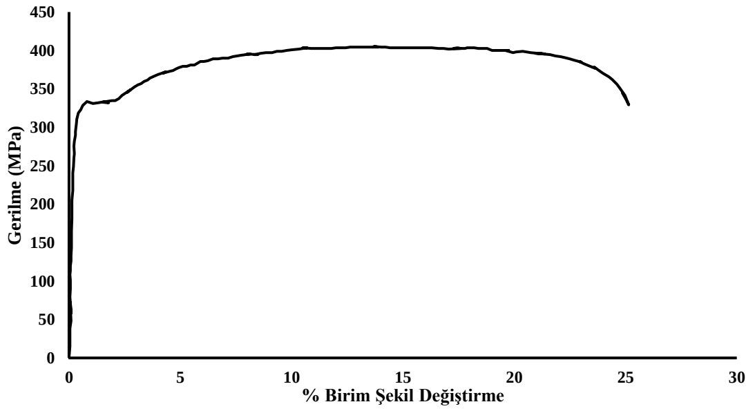
Şekil 4.3. 2 mm kalınlıktaki numune için gerilme-birim şekil değişirme eğrisi.
