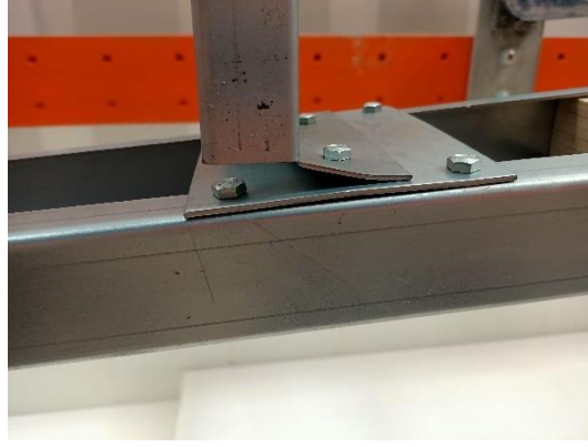
Şekil 4.52 (devam). Bağlantı kirişi levhasında oluşan lokal ezilme (c).
