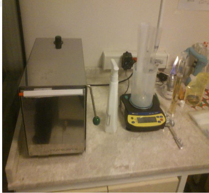
Şekil 30 : Stomacher cihazı ve tartım işlemi
