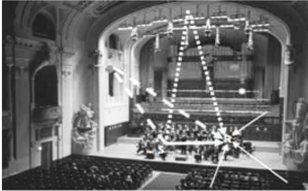
Resim 2.1. Konser salonu sahnesinde ses yansımalarının şematik gösterimi
