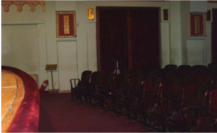
Resim 3.10. Ölçümün yapıldığı bir alıcı noktasına yerleştirilmiş mikrofon
