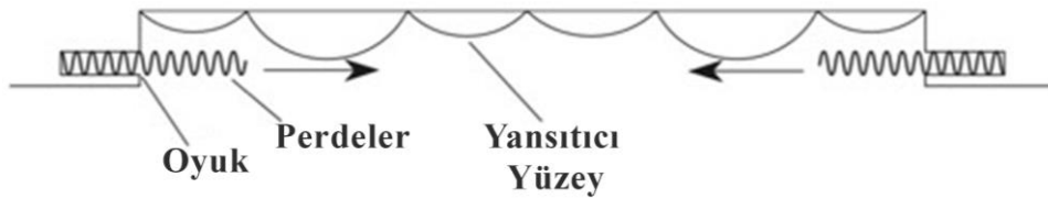
Şekil 18. Yüzeyler üzerine perde uygulaması (Everest & Pohlmann, 2022)
