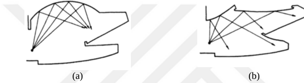
Şekil 15. Konser salonlarında; (a) kötü ve (b) iyi tavan uygulamaları
