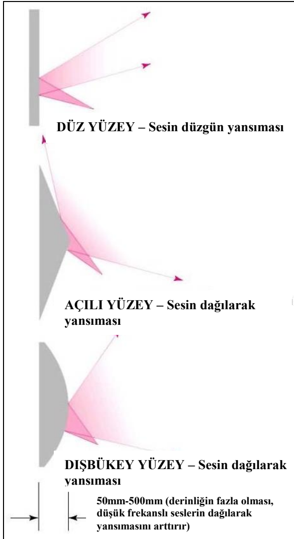
Şekil 3.3. Düz yüzey, açılı yüzey ve dışbükey yüzeylerden sesin yansıması [10]
