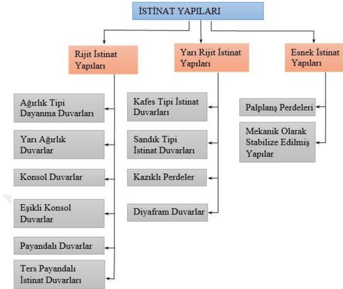
Şekil 2. İstinat duvarlarının sınıflandırılması
