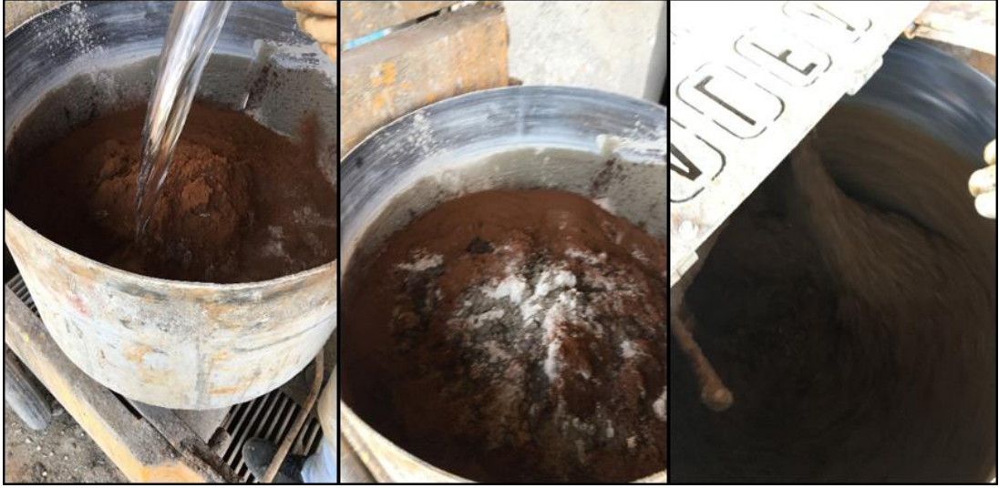
Şekil 4.16. Beton mikserindeki betonun karıştırılma esnasındaki görüntüsü
