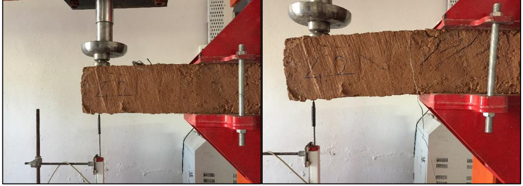
Şekil 5.5. Kırılma işlemi başlamadan ve başladıktan sonraki durumlar
