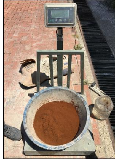
Şekil 4.14. Demir tozunun hazırlanması
