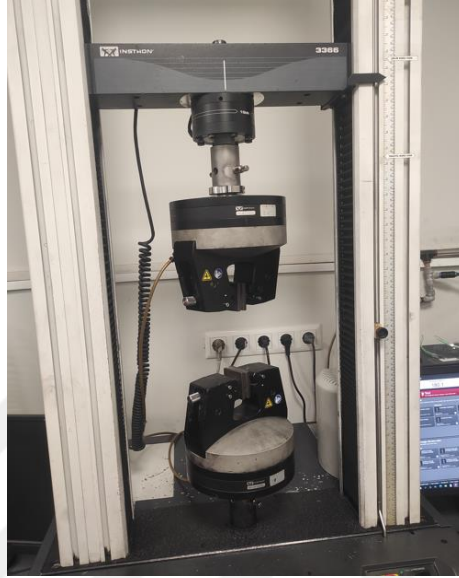
Şekil 6.1. Instron 3366 Çekme Test Cihazı.
