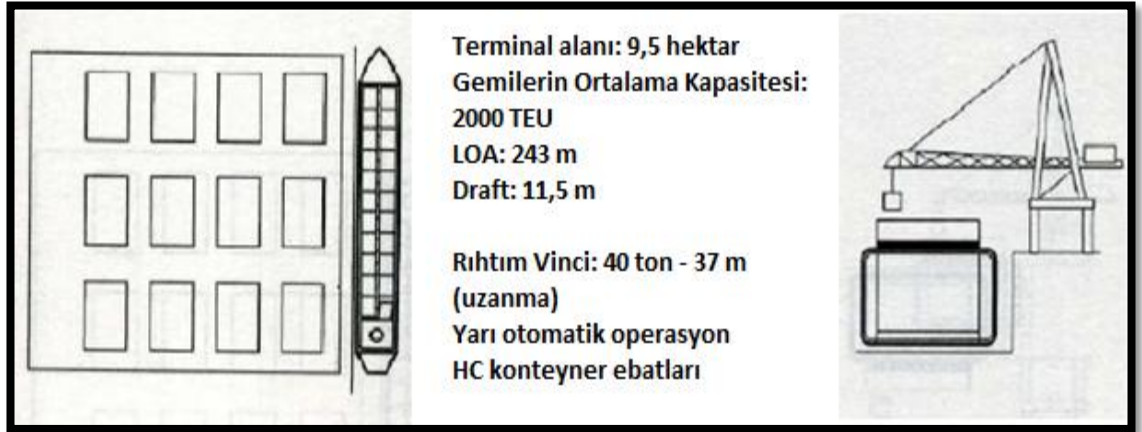
Şekil 6: 1980’lerde Konteyner Terminal Yapısı
