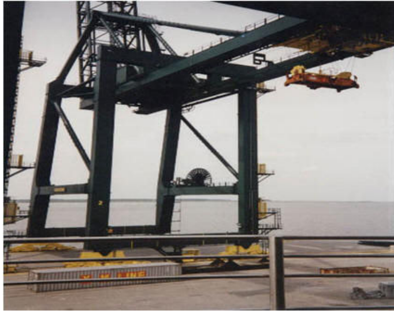
Şekil 4.2 Post-panamax gemileri için post-panamax konteyner elleçleme ekipmanı
