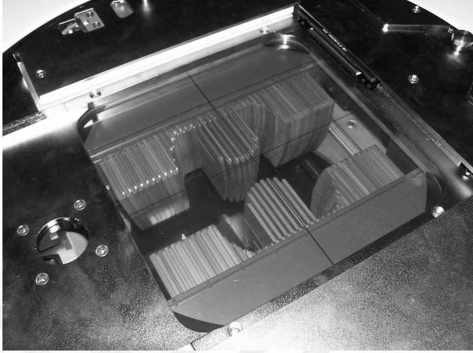
Resim 2.2 Çok Yapraklı Kolimatör (ÇYK) Yapısı
