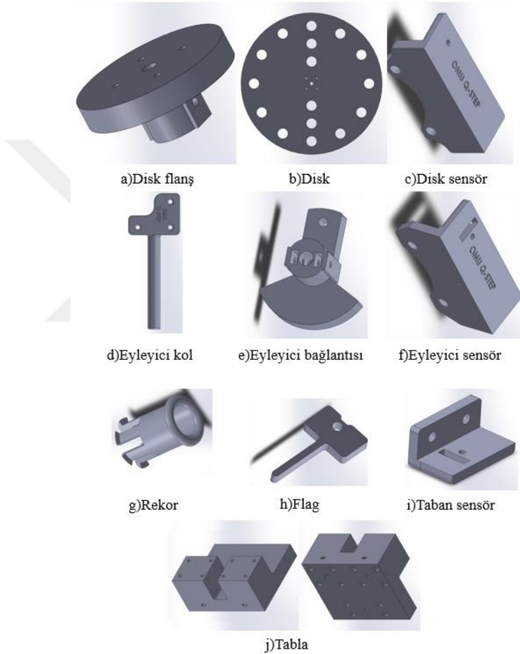
Şekil 2.21. Eğitim seti üç boyutlu imalat çizimleri
