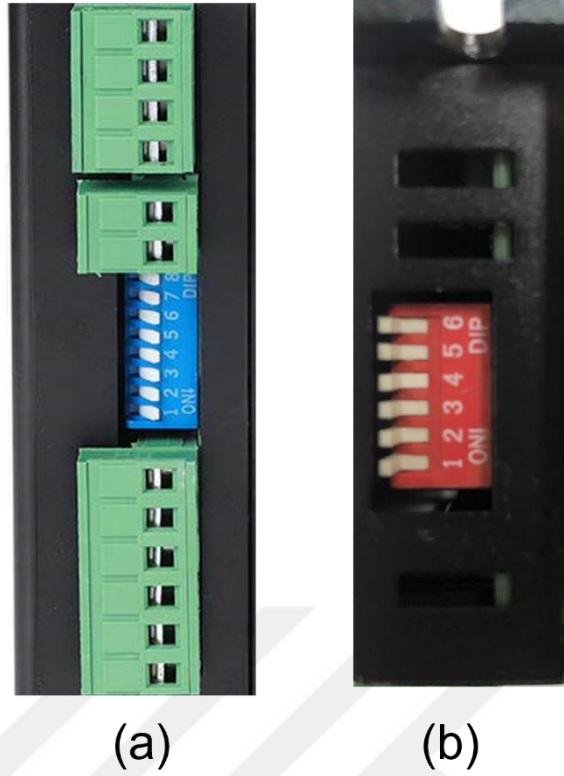
Şekil 2.6. (a) CWD556 anahtar ayarları, (b) Microstep anahtar ayarları
